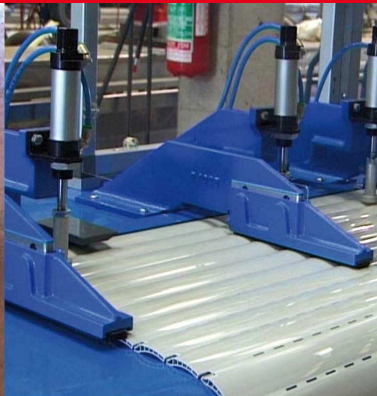
Dettaglio dell'avvolgibile durante il confezionamento Detail of the roller shutter during the assembly phase
